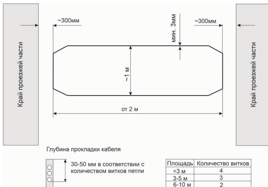
Рисунок 6.9.2.2 Схема монтажа петли
