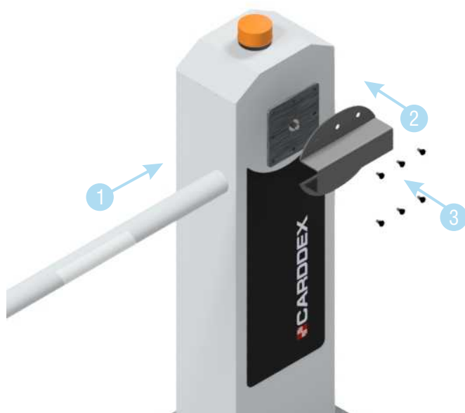
Рисунок 7.4.1 Установка стрелы на шлагбаум
