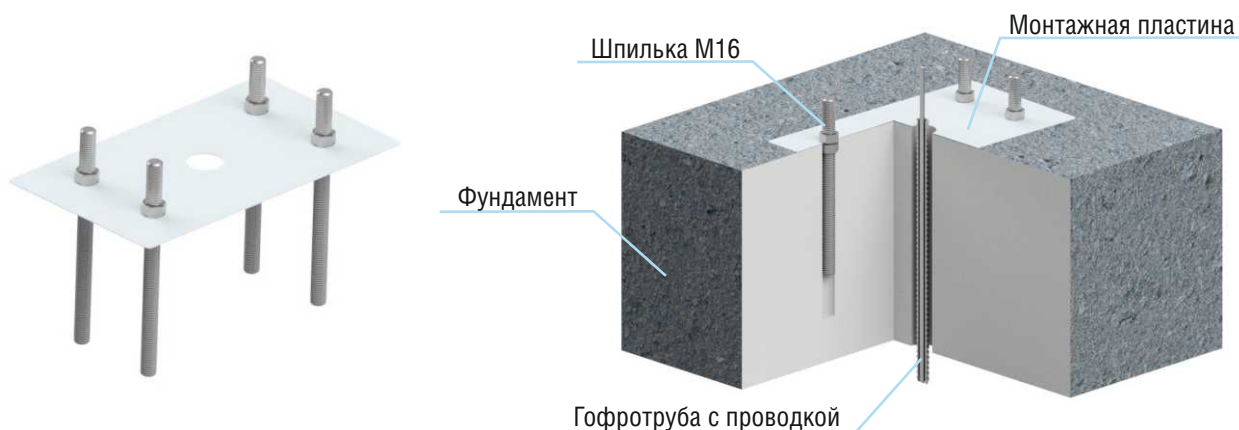
Рисунок 7.2.1 Устройство фундамента с монтажным комплектом
