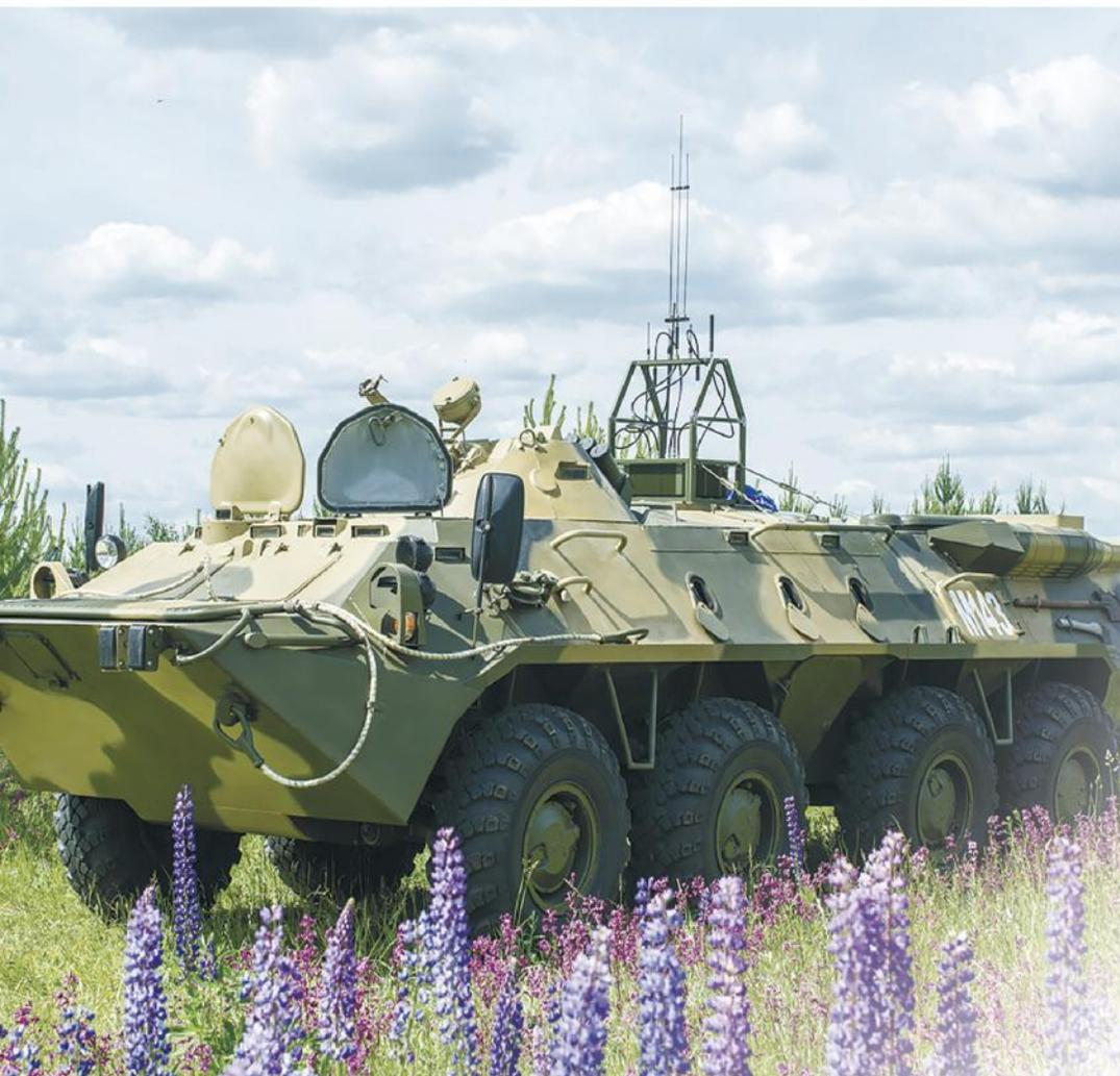
Изделие предназначено для противодействия радио-взрывным устройствам (РВУ) посредством генерируемого сигнала во всем диапазоне рабочих частот, устанавливается на транспортное средство и предназначено для защиты от РВУ при передвижении и в стационарном положении. Для защиты блокиратора от внешних механических воздействий предусмотрен каркас для крепления бронежилета, что позволяет эффективно использовать устройство в условиях ведения боевых действий.
