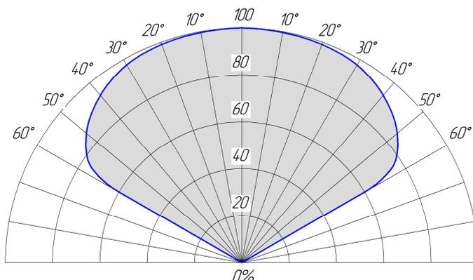
Рисунок 2 – Диаграмма чувствительности извещателя (в % указана чувствительность в зависимости от ТП5 и ТП6 в метрах)
