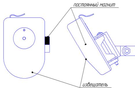
Рисунок 4 – Место хранения постоянного магнита
