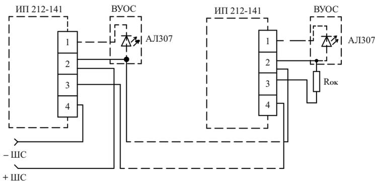
Схема подключения извещателей к двухпроводным шлейфам со знакопеременным напряжением.
